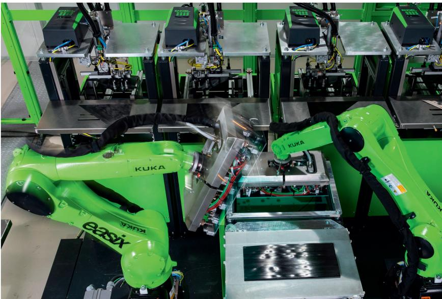
Für eine hohe Fertigungseffizienz wird eine Tapelegezelle vorzugsweise mit zwei Robotern und einer Kamerastation ausgerüstet © Engel
