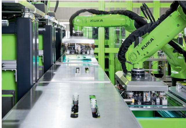
**Bild 5.** Die Tapezuschnitte werden an den Stapelmagazinen vereinzelt und auf Abholtischen für die Roboter auf Position gehalten
